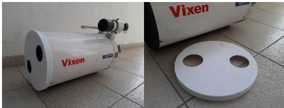
Gambar 1. Kiri: Teleskop reflektor 8 inch (Vixen VMC200L). Kanan: Hartmann Mask yang digunakan hasil 3D-printing.
