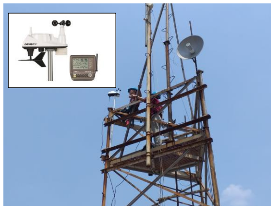
Gambar 1. AWS diletakkan pada salah satu menara antenna. Inset: AWS Davis™ Vantage Vue dan perangkat receiver -nya.
